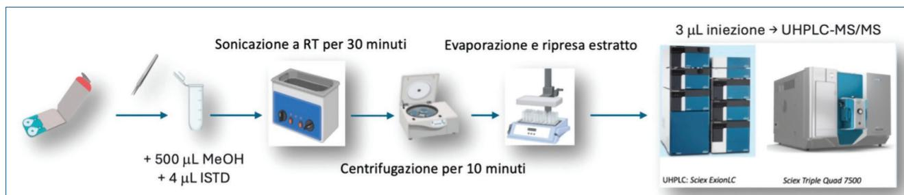
Fig. 3 - Workflow della procedura di estrazione per l'analisi di PFAS su campioni DBS da 10 µL
